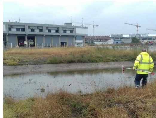
Εικόνα 25 SKG δειγματοληψία επιφανειακών απορροών από τάφρο ομβρίων, με χρήση ειδικού δειγματολήπτη.
