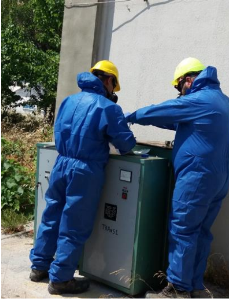
Εικόνα 25: Δειγματοληψία ηλεκτρικής συσκευής για PCB, από αδειοδοτημένη εταιρεία, στον αερολιμένα MJT.
