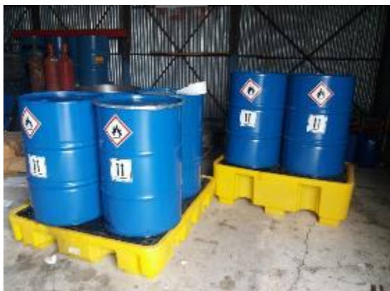
Εικόνα 13: Βαρέλια για την αποθήκευση χρησιμοποιημένων ελαίων σε εσωτερικό χώρο. Τα χρησιμοποιημένα έλαια αποστέλλονται προς ανακύκλωση δια μέσω του αντίστοιχου Συστήματος Εναλλακτικής Διαχείρισης.
