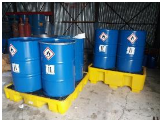
Εικόνα 16: Βαρέλια για την αποθήκευση χρησιμοποιημένων ελαίων σε εσωτερικό χώρο. Τα χρησιμοποιημένα έλαια αποστέλλονται προς ανακύκλωση δια μέσω του αντίστοιχου Συστήματος Εναλλακτικής Διαχείρισης.
