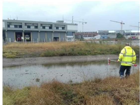
Εικόνα 9: SKG δειγματοληψία επιφανειακών απορροών από τάφρο ομβρίων, με χρήση ειδικού δειγματολήπτη.
