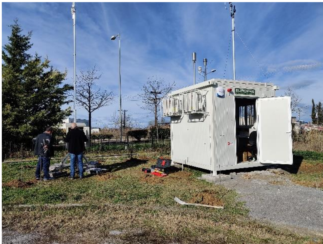
Εικόνα 11: Σταθμός παρακολούθησης αέριας ρύπανσης στο Νέο Ρύσιο (Σημείο MP01, Γήπεδο μπάσκετ) στον αερολιμένα Θεσσαλονίκης SKG.
