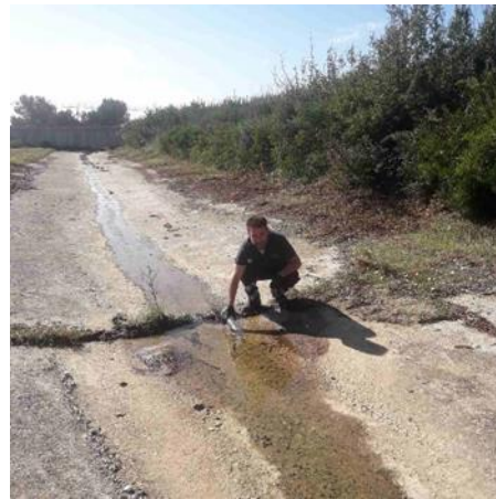
Εικόνα 3: EFL δειγματοληψία επιφανειακών απορροών από τάφρο ομβρίων,.
