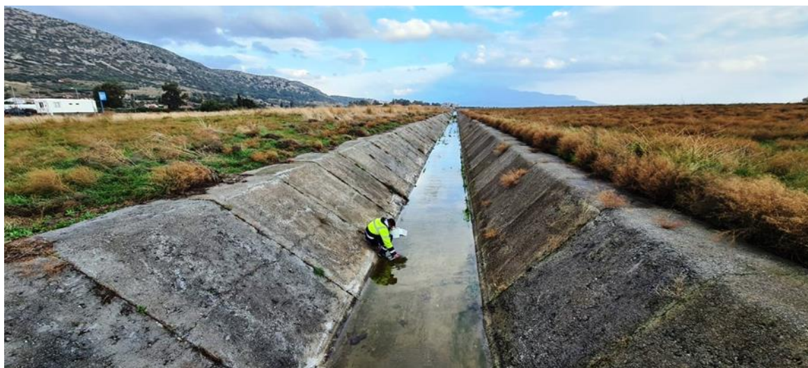
Εικόνα 2: SMI δειγματοληψία επιφανειακών απορροών από τάφρο ομβρίων.
