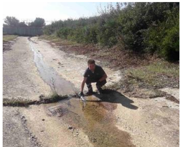
Εικόνα 3: EFL δειγματοληψία επιφανειακών απορροών από τάφρο ομβρίων
