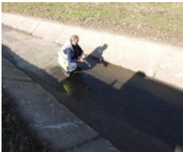
Εικόνα 2: KVA δειγματοληψία επιφανειακών απορροών από τάφρο ομβρίων
