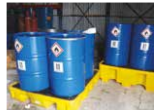
Βαρέλια για την αποθήκευση χρησιμοποιημένων ελαίων σε εσωτερικό χώρο. Τα χρησιμοποιημένα έλαια αποστέλλονται προς ανακύκλωση διαμέσω του αντίστοιχου Συστήματος Εναλλακτικής Διαχείρισης.
