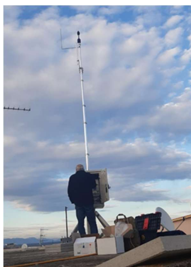
Εικόνα 8: Σταθμός παρακολούθησης θορύβου (MP01) στη Ρόδο.
